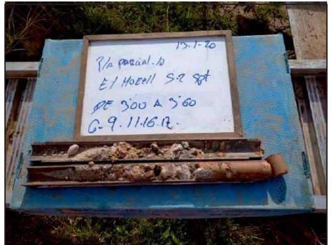
Assaig SPT realitzat al sondeig S-2 entre 3,0 i 3,6 m.
