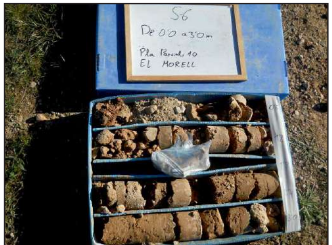
Caixa de testimonis del sondeig S-6 entre 0,0 i 3,0 m.
