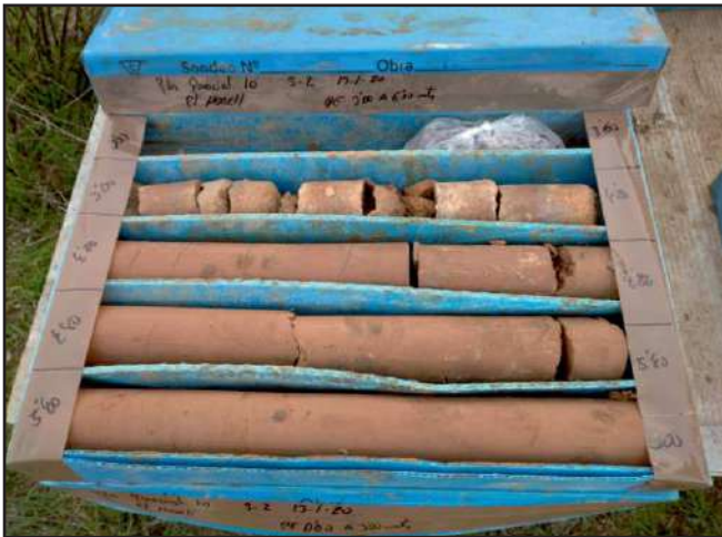
Caixa de testimonis del sondeig S-2 entre 3,0 i 6,0 m.
