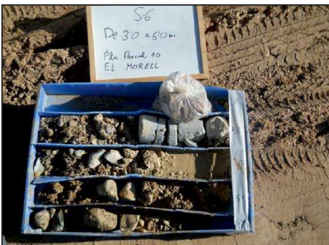
Caixa de testimonis del sondeig S-6 entre 3,0 i 6,0 m.
