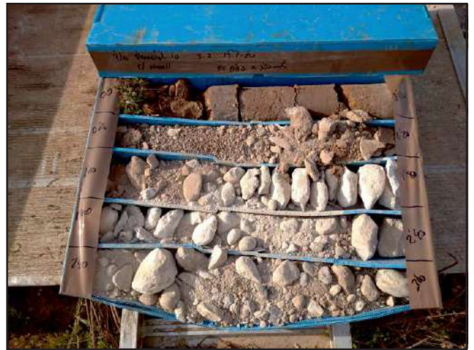
Caixa de testimonis del sondeig S-2 entre 0 i 3 m.
