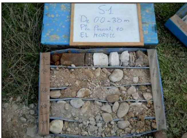
Caixa de testimonis del sondeig S-1 entre 0,0 i 3,0 m.
