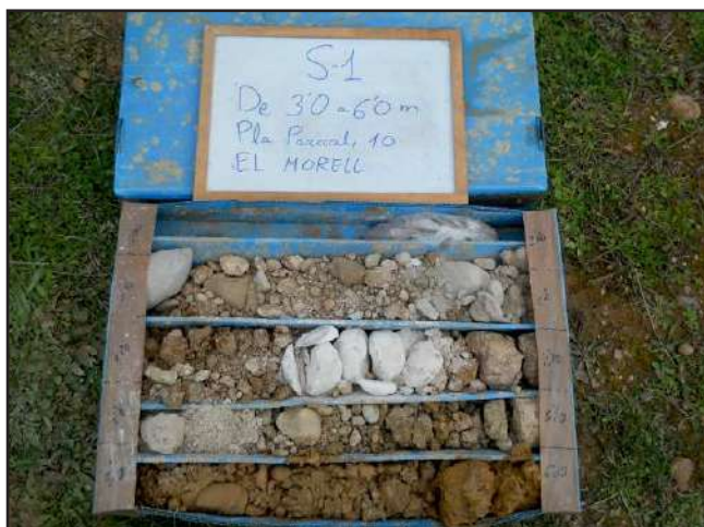
Caixa de testimonis del sondeig S-1 entre 3,0 i 6,0 m.
