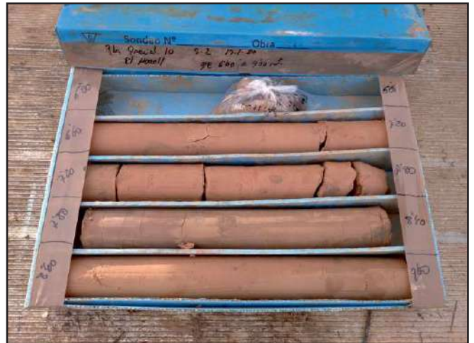
Caixa de testimonis del sondeig S-2 entre 6,0 i 9,0 m.
