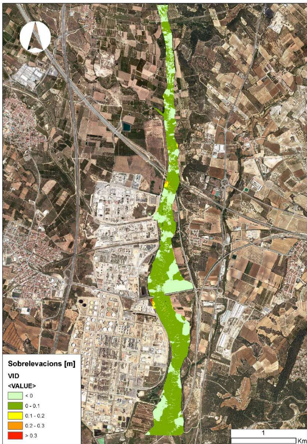
Figura 13. Mapa de sobreelevacions emprant una Via d'Intens Desguàs (VID) igual al contorn exterior de la Zona de Danys Greus (ZDG). La Zona de Flux Preferent proposta és el contorn exterior del polígon.
