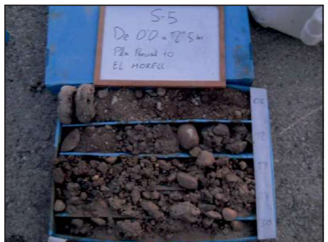
Caixa de testimonis del sondeig S-5 entre 0,0 i 3,0 m.
