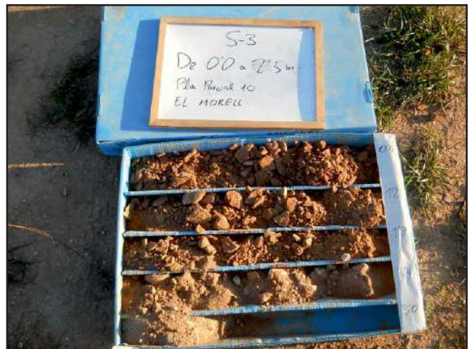
Caixa de testimonis del sondeig S-3 entre 0,0 i 2,5 m.
