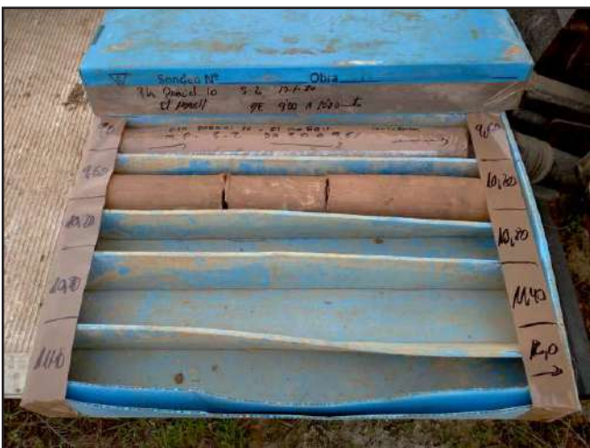
Caixa de testimonis del sondeig S-2 entre 9,0 i 10,2 m.
