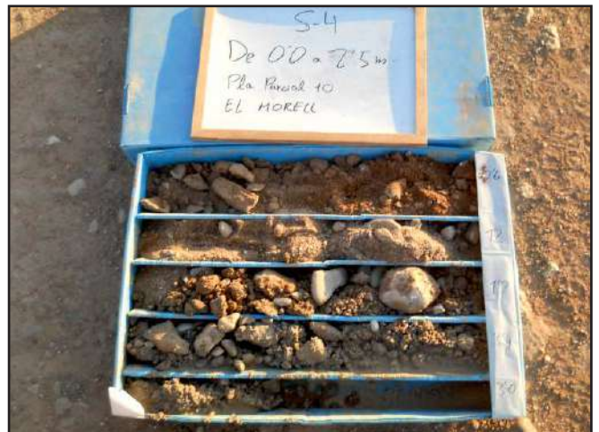
Caixa de testimonis del sondeig S-4 entre 0,0 i 2,5 m.
