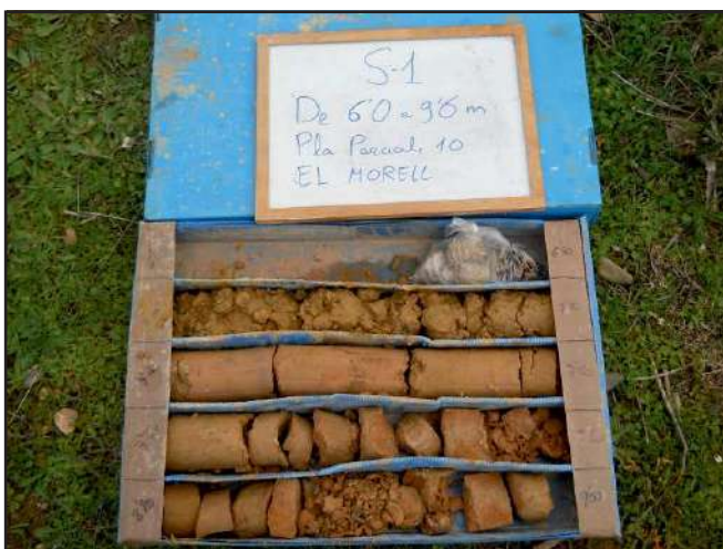
Caixa de testimonis del sondeig S-1 entre 6 i 9 m.
